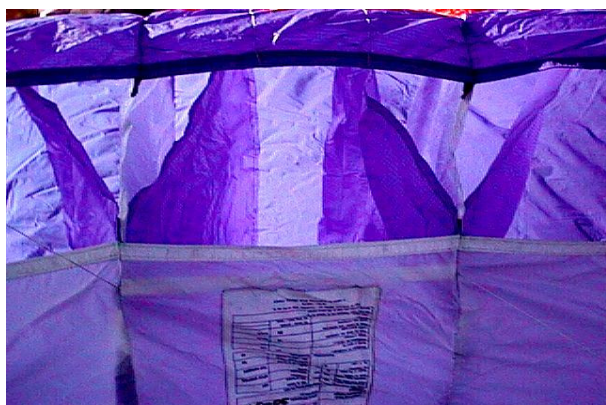
Diagonál bordaelrendezés a beömlőnyíláson át nézve
