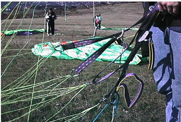
A CD hevederek hosszát kézzel változtató heveder (trimmer)
