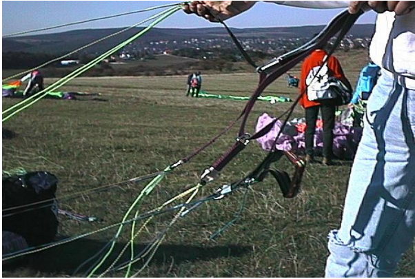
Az ABC hevederek hosszát változtató kétszigás, lábgyorsító heveder
